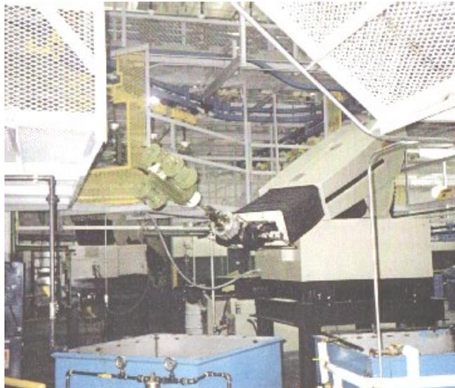
Figura 1.2.- Robot Industrial UNIMATE de la serie 5000
