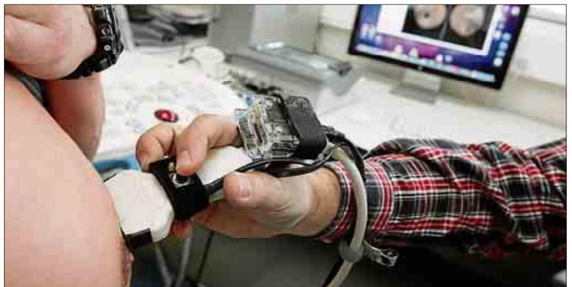
El ingenio se puede instalar en cualquier ecógrafo para recoger los datos en un ordenador. DIEGO FOTÓGRAFOS
